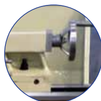
Contraponto ajustável. Manga do contraponto e volante graduados em 0.02 mm. Metal temperado por indução (HRC 42-52) e base e fundição rectificada de elevada rigidez com guias em "V".
