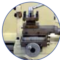
Guias de precisão. Volantes com graduações reguláveis de 0.04 / 0.01 mm. Porta ferramentas quadrado. Guias robustas.
